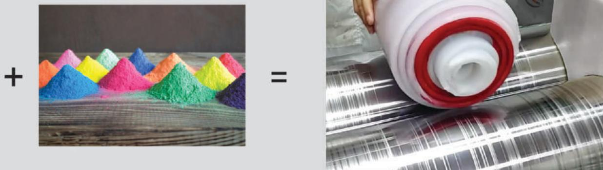
کامپاند سیلیکونی چیست؟ کامپاندهای سیلیکونی HTV جامد مورد استفاده در عایق و روکش سیم و کابل ها از ترکیب چند جزء تشکیل می شوند. که شامل سیلیکون + پودرها (جهت بهبود برخی خواص و شرایط سیلیکون) + رنگدانه ها + تثبیت کننده ها می باشند. کامپاندها بر مبنای استانداردهای موجود و مورد درخواست مشتری فرمول دهی و ترکیب می شوند.
