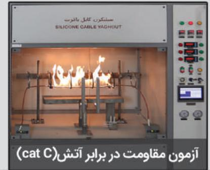
هدف از انجام این آزمون مشاهده حفظ یکپارچگی مدار تحت شرایط آتش به تنهایی در ولتاژ نامی کابل مطابق با استاندارد BS 6387 و همچنین IEC 60331-21 می باشد.
