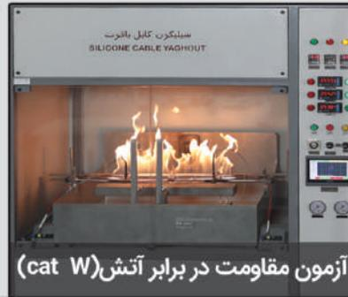
هدف از انجام این آزمون مشاهده حفظ یکپارچگی مدار تحت شرایط آتش به همراه اسپری آب در ولتاژ نامی کابل مطابق با استاندارد BS 6387 می باشد.
