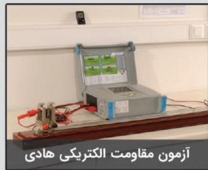
هدف از انجام این آزمون اندازه گیری مقاومت اهمی هر متر هادی استفاده شده در سیم و کابل مطابق با استانداردهای ISIRI 3084 می باشد.
