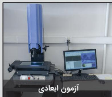
هدف از انجام این آزمون مشاهده ستر بودن سیم و کابل و اندازه گیری ضخامت و قطر عایق و روکش سیم و کابل می باشد.
