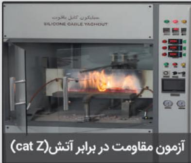
هدف از انجام این آزمون مشاهده حفظ یکپارچگی مدار تحت شرایط آتش به همراه شوک مکانیکی در ولتاژ نامی کابل مطابق با استاندارد BS 50200 و BS 6387 می باشد.
